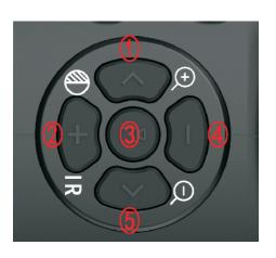
①数码变焦 + ; 在菜单模式下向上移动光标; 回放模式下向上翻页。 ②长按切换黑白模式; 黑白模式下短按增加红外强度; 回放模式下视频快退。
