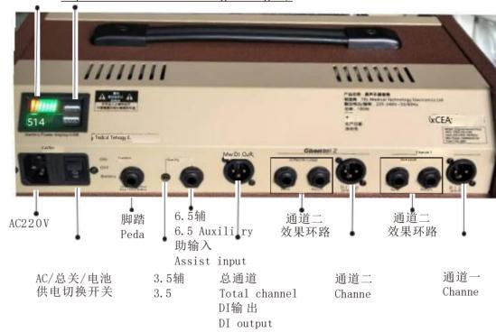
注意: 电源开关拔到ON时给设备供市 电 的 同时也在对 内部 电池充 电,不影响使用。 拔掉电源线时同时电池恢复供电,有利于交流突然断电时设备保护不间断 使用,但平时使用电池时建议拔到BATTERY电池档使用。
