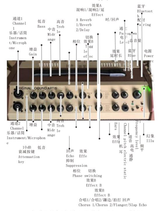
注意: 使用原声音时将通道1和2的切换效果B关闭即可, 黄色指灯灭。
